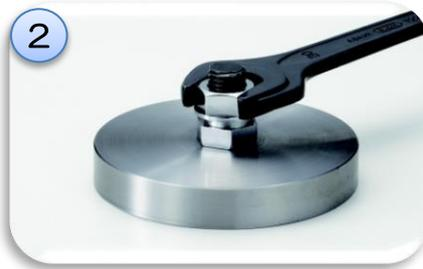
2 用意した工具を用い凹ナットを取外します。錆などが発生している場合は浸透性の良い減摩材を塗布して下さい。供回り防止の為、凸ナットも工具で止めて作業して下さい。
