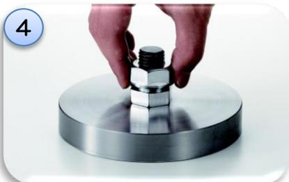
次に凹ナットを、手でセットして下さい。この時に凹凸ナット隙間が1ピッチ程度ある事を確認して下さい。
