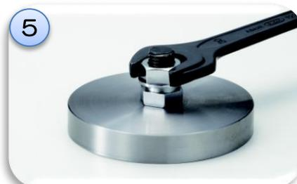
凸ナット同様、凹ナットを締結して下さい。(凹ナット参考締付けトルク参照)
