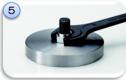
5 用意した工具を用い凸ナットを取外します。インパクトレンチは使用しないで下さい。
